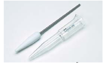
Glasgefäß mit Erweiterung als Überlauf mit Ausguss, mit PTFE-Pistill, konisch
